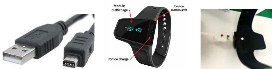
Figure 3 Câble de charge Micro-D (L) ; Montre à capteur SpO2 (M) ; Point rouge marqué sur le câble de charge SpO2 et la montre (R)
