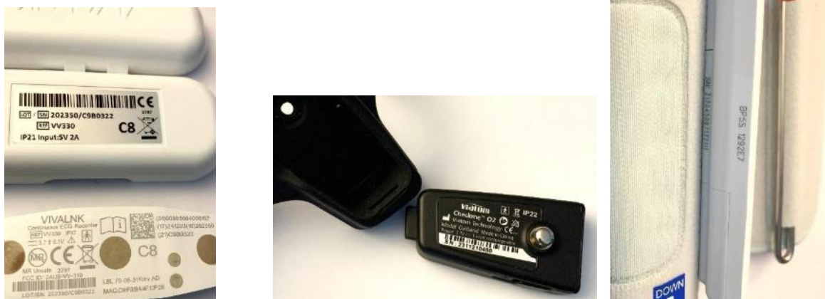
Figure 9 Emplacement de l'identifiant du capteur dans le patch MVS (L), capteur SpO2 (M), capteur BP (R)
