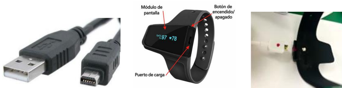
Figura 3 Cable de carga Micro-D (L); Reloj con sensor SpO2 (M); Punto rojo marcado en el cable de carga SpO2 y el reloj (R)
