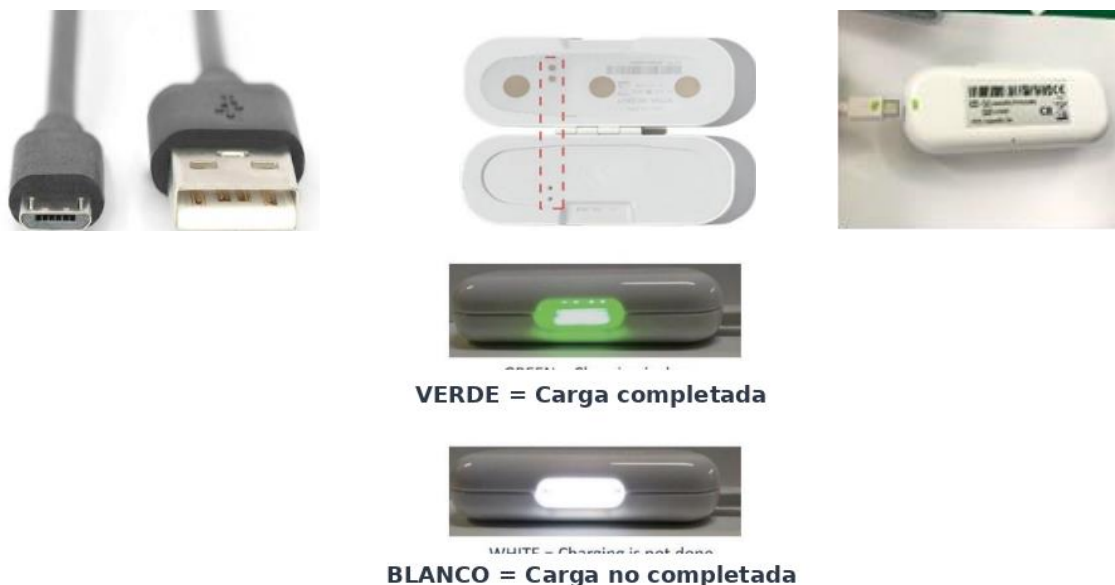
Figura 2 Cable de carga Micro-B (L); dos puntos de carga en el estuche MVS (M); Punto verde marcado en el parche MVS y el cable de carga (R)
